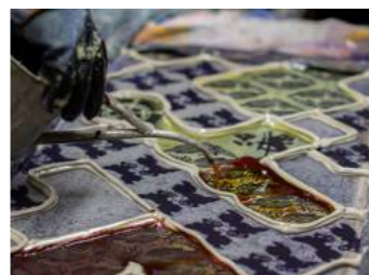
浪華本染め「注染」は、明治時代に大阪で生まれた染色技法で、日本の染め物の歴史に新しい風を吹き込んだ。おもに手ぬぐいや浴衣に用いられ、職人が手作業で表裏両面から染めるため、使い込んでも色褪せにくい。国の伝統的工芸品に指定されている。
